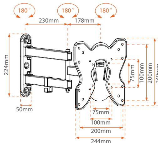
Questo supporto permette di fissare un televisore da 71 a 106cm alla parete liberando così il mobile TV per mettere altri dispositivi multimediali (decoder, console, DVD, etc.). Grazie al braccio regolabile, alla rotazione di 180° ed inclinazione verticale di 15°, è possibile regolare perfettamente il televisore per una buona visibilità da ogni posizione.
