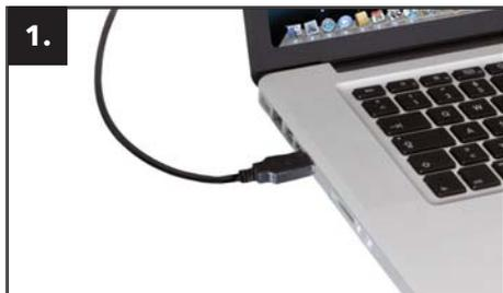
Collegare il cavo USB alla porta di interfaccia del computer. Per la maggior parte dei computer, l'alimentazione proveniente dalla porta di trasferimento dati sarà sufficiente.
