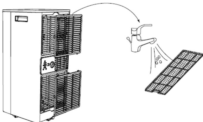
I filtri dell'aria devono essere controllati almeno una volta ogni due settimane di funzionamento. Il funzionamento con filtri sporchi o intasati causa sempre una diminuzione dell'efficienza del climatizzatore e può provocare inconvenienti gravi.
