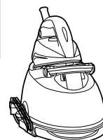
Fig. 9: Armazenamento do cabo
