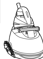
fig. 9: Almacenamiento del cable
