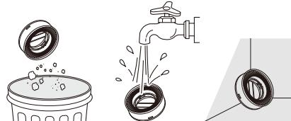
5. Allineare il filtro di scarico alla posizione aperta e ruotarlo in senso orario nella posizione bloccata ④ per montarlo sul corpo del prodotto.
