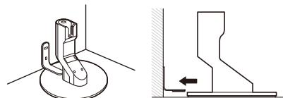
2. Praticare 2 fori nel muro di cemento nella posizione selezionata per inserire i tasselli. Non è consigliabile fissare la staffa a una parete in gesso o cartongesso poiché qualsiasi impatto o forza sulla staffa può danneggiare la parete o i suoi elementi di fissaggio.
