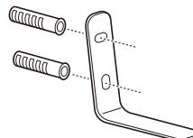
3. Utilizzare le viti di fissaggio a parete per fissare la staffa di montaggio a parete a forma di 'L' al muro di cemento.
