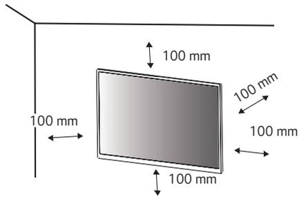
Per installare il monitor su una parete, fissare una staffa per montaggio a parete (opzionale) al retro del monitor:
