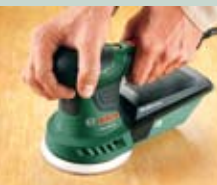
Preparazione/levigatura fine da K 80 a K 240
