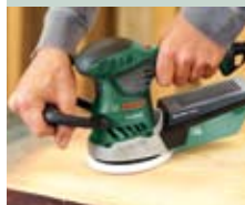
Preparazione/levigatura fine da K 80 a K 240
