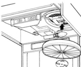
O ar, por passagens sucessivas através do filtro, é reintroduzido purificado no ambiente da cozinha. O filtro de carvão não pode ser lavado e tem de ser substituído de três em três meses, em média,. Para retirar o filtro de carvão, abra a grelha metálica de aspiração e rode o filtro, ligeiramente, no sentido contrário aos ponteiros do relógio com a mão, exercendo simultaneamente uma leve pressão. Para o voltar a montar, proceda pela ordem inversa de sucessão das operações descritas.
