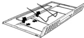
Die Funktion des Fettfilters besteht darin, die in der Luft vorhandenen Fettpartikel aufzufangen. Er befindet sich hinter dem Sauggitter und kann aus synthetischem Material oder Metall sein. Die Wartung hängt vom Fettfiltertyp ab: synthetische Fettfilter können nicht gereinigt werden und sind alle drei Monate auszutauschen.
