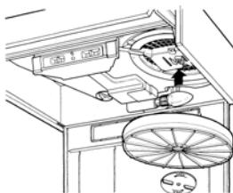
El aire vuelve a ser introducido en la cocina, una vez depurado, tras varios pasajes a través del filtro. El filtro al carbón no se puede lavar y hay que substituirlo más o menos cada tres meses. Para quitar el filtro al carbón, abrir la rejilla metálica de aspiración y girar ligeramente el filtro en sentido contrario a las agujas del reloj realizando al mismo tiempo una ligera presión. Para volver a montarlo repetir la operación al contrario.
