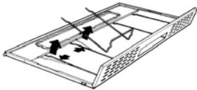
Det har til opgave at tilbageholde fedtpartiklerne i luften. Det er placeret indvendigt i udsugningsristen og kan være fremstillet af enten syntetisk materiale eller metal. Vedligeholdelsen af fedtfiltret varierer afhængigt af den anvendte type. Det syntetiske fedtfilter kan ikke vaskes og skal derfor udskiftes hver tredje måned. Fedtfilteret af metal skal afvaskes en gang om måneden i varmt vand og rengøringsmiddel. Undgå at bøje det. Lad det tørre, før det sættes på plads igen.
