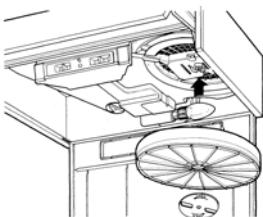
Den renade luften släpps in igen i köket efter efterföljande passager genom filtret. Kolfiltret kan inte diskas och ska ersättas i genomsnitt var tredje månad. För att ta bort kolfiltret, öppna metallgrillen för utsugningen och vrid lätt filtret moturs med en hand och tryck lätt samtidigt. För att återmontera det kasta om operationerna.
