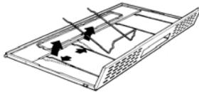
Функция фильтра заключается в задержании взвешенных частиц жира. Фильтр находится с внутренней стороны всасывающей решетки и может быть либо из синтетического материала, либо из металла. Уход за противожировым фильтром зависит от его типа. Противожировой синтетический фильтр нельзя мыть, его следует менять раз в три месяца. Противожировой металлический фильтр следует мыть каждый месяц теплой водой и моющим составом, следя за тем, чтобы он не погнулся. Высушить фильтр и поставить его на место.
