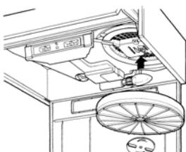
Understøt filteret med den ene hånd for at udskifte lugtfiltret, træk den runde skive ud gennem lugtfiltrets midte, og drej den, indtil filteret frigøres.
