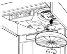
**HUOMIO!** Jos suodattimia ei puhdisteta ja vaihdeta valmistajan ohjeiden mukaan, on olemassa tulipalovaara. Rasvasuodattimen irrottamiseksi avaa imuritilä ja poista metalli-lankakiinnikkeet.
