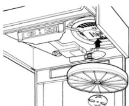
**ВНИМАНИЕ!** Если фильтры не очищаются и не заменяются согласно инструкциям производителя, может возникнуть опасность пожара. Чтобы снять противожировой фильтр, необходимо открыть всасывающую решетку и вынуть специальные фиксаторы фильтра из металлической проволоки.
