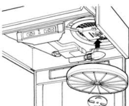
**ATTENZIONE! C'è un possibile rischio di incendio se i filtri non sono puliti e sostituiti secondo le istruzioni del produttore. Per rimuovere il filtro antigrasso è indispensabile aprire la griglia di aspirazione e rimuovere gli appositi ferma filtro in filo metallico.**
