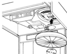
Aktivkohlefilter können nicht gereinigt werden und sind im Durchschnitt alle drei Monate auszutauschen. Bei Entnahme des Kohlefilters ist nach dem Öffnen des Metall-Sauggitters folgendermaßen vorzugehen: bei Bajonettverschluss wird der Filter locker gegen den Uhrzeigersinn gedreht, wobei man mit der Hand leicht andrückt. Bei Wiedereinbau des Filters ist in umgekehrter Reihenfolgen vorzugehen.
