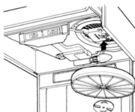
**ATTENTION! Nous recommandons de suivre attentivement toutes les instructions données pour le nettoyage et le remplacement des filtres a fin d'éviter un possible danger d'incendie. Pour remplacer le filtre à graisse il faut ouvrir la grille d'aspiration et déplacer les arrêts-filtre en fil métallique.**
