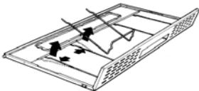
Dess funktion är att behålla fettpartiklar i suspension. Det sitter invändigt utsugningsgrillen och kan leveras i syntetmaterial eller metall. Underhållet av fettfiltret varierar enligt använd typ. Det syntetiska fettfiltret kan inte diskas och ska bytas var tredje månad. Metallfettfiltret ska diskas varje månad i varmt vatten och diskmedel och undvika att vika det. Låt det torka innan du monterar tillbaka det.
