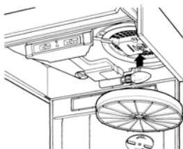
Indien de filter voorzien is van een bajonnetaansluiting, de filter tegen uurwijzerszin draaien en lichtjes druk uitoefenen met één hand. Om de filter terug te monteren, in tegengestelde zin te werk gaan.
