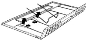
Tem a função de reter as partículas de gordura em suspensão. Está colocado na parte de dentro da grelha de aspiração e pode ser de material sintético ou de metal. A manutenção do filtro anti-gordura varia de acordo com o tipo de filtro usado. O filtro anti-gordura sintético não pode ser lavado e tem de ser substituído de três em três meses. O filtro anti-gordura de metal deve ser lavado todos os meses com água quente e detergente, evitando dobrá-lo. Deixe secar antes de o voltar a montar.
