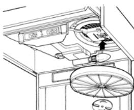
Lufta blir sendt renset ut igjen i kjøkkenet, klar til senere under gjennom filteret. Kullfilteret kan ikke vaskes og må skiftes ut i gjennomsnitt hver 3. måned. For å fjerne kullfilteret må man åpne metallristen fra sugeenheten og vri filteret litt mot venstre med en hånd, samtidig som man trykker lett på det. For å montere det tilbake på plass gjentar man prosedyren i motsatt rekkefølge.
