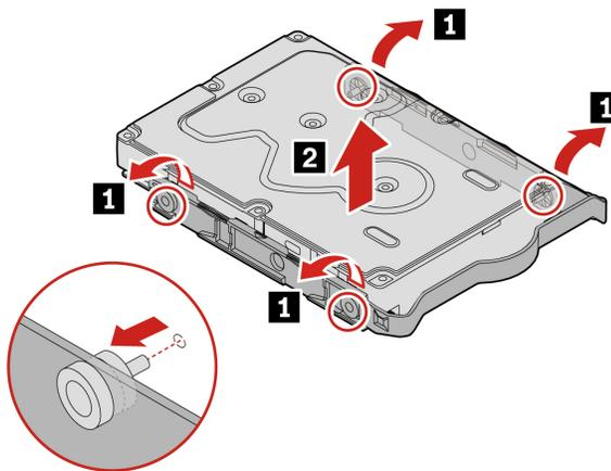
**Procedura di rimozione dell'unità di memorizzazione primaria da 2,5 pollici, del convertitore unità di memorizzazione e della staffa**
