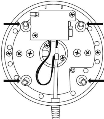
Vous pouvez également utiliser les 4 perforations situées dans les coins des plaques métal du joystick et des manettes des gaz pour fixer l'ensemble sur un support fixe.
