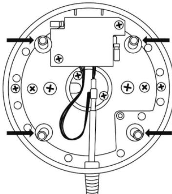
Du kan även använda de fyra hålen i hörnen av joystickens och gasreglagets metallbasplattor för att fästa båda delarna till ett fast stöd.
