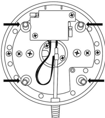
Pro připevnění joysticku můžete také použít 4 otvory umístěné v rozích desky kovové základny joysticku a společně připevnit jak joystick, tak i ovládání tahu motorů k pevné podpěře.
