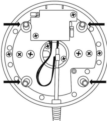
Ponadto korzystając z 4 otworów znajdujących się w narożnikach metalowych podstaw joysticka i dźwigni przepustnicy, można zamocować oba te elementy na stałej podporze.
