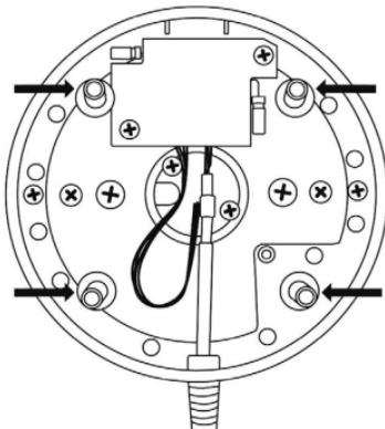
También puedes utilizar los 4 agujeros situados en las esquinas de las placas de la base metálica del joystick y el mando de potencia para fijar ambos elementos a un soporte fijo.
