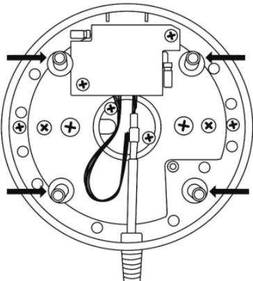
U kunt ook de 4 gaten op de uithoeken van de metalen onderplaten van de joystick en de throttle gebruiken om beide onderdelen op een vaste steun te bevestigen.
