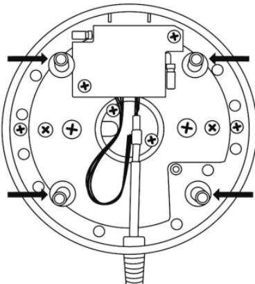
Também pode utilizar os 4 furos situados nos cantos da base de metal do joystick e da manete para prender ambos os elementos a um suporte fixo.
