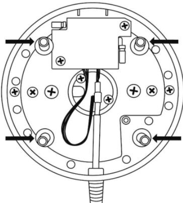
Также можно прикрепить джойстик и рычаг управления двигателем к конструкции с помощью 4-х отверстий, расположенных по углам металлической поверхности.
