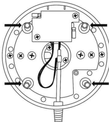
Na pripojenie oboch prvkov k pevnému podkladu môžete tiež použiť 4 otvory umiestnené v rohoch kovových dosiek základne joysticku a plynovej páky.
