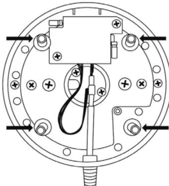
In alternativa, per fissare joystick e manetta ad un supporto fisso, puoi utilizzare i 4 fori posti agli angoli delle placche metalliche presenti nelle basi di entrambi gli elementi.
