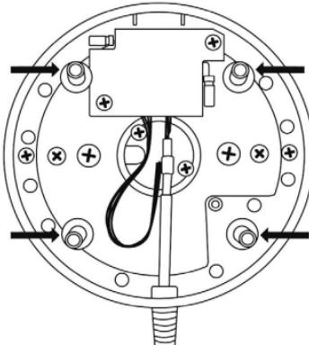
Sie können die vier Löcher in den Ecken der metallenen Basisplatten des Joysticks und des Gashebels dazu benutzen, beide Elemente auf eine Halterung zu montieren.
