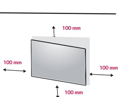
Per installare il monitor su una parete, fissare una staffa di montaggio a parete (opzionale) alla parte posteriore del monitor.
