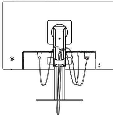
Girare il Set (Perno) e mettere i connettori. È facile mettere i connettori e gestire i cavi usando il supporto di cavo.
