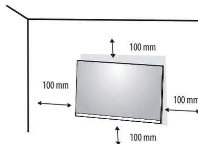
Per installare il monitor su una parete, fissare una staffa per montaggio a parete (opzionale) al retro del monitor. Assicurarsi che la staffa per montaggio a parete sia fissata saldamente al monitor e alla parete.
