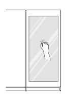
Battere due volte sul vetro per attivare o disattivare la luce al LED all'interno del **Door in Door**.
