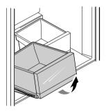
Montare il cassetto del frigo nell'ordine inverso rispetto alla procedura di rimozione.
