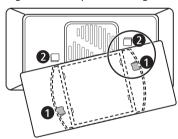
5 Ruotare il coperchio del filtro dell'aria in senso orario fino ad innestare i ganci e bloccare il coperchio in posizione.
