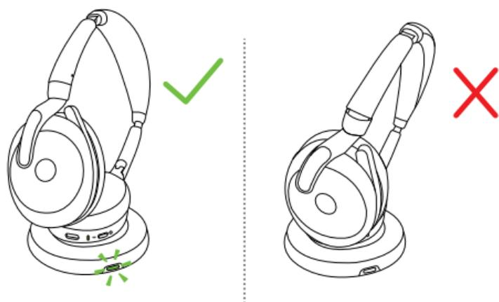
Il LED di stato sulle cuffie lampeggerà in rosso, giallo o verde per indicare l'attuale stato della batteria. Quando le cuffie con microfono sono completamente cariche, il LED sulle cuffie con microfono e sul pad di ricarica si spegnerà.
