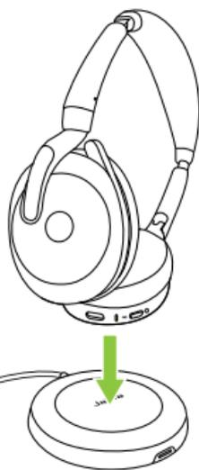
Il LED sul pad di ricarica wireless si accende per indicare che il padiglione sinistro è stato posizionato correttamente sul pad di ricarica wireless e che le cuffie si stanno caricando.
