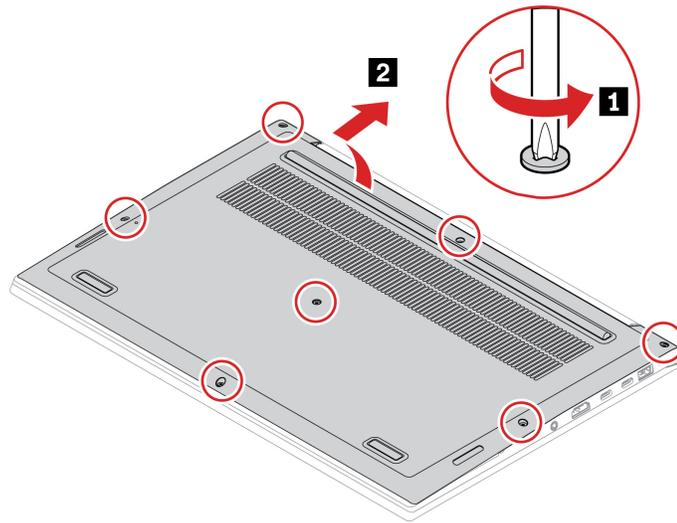
5. Installare il nuovo assieme del coperchio della base **1** e stringere le viti per fissare l'assieme del coperchio della base **2**.
