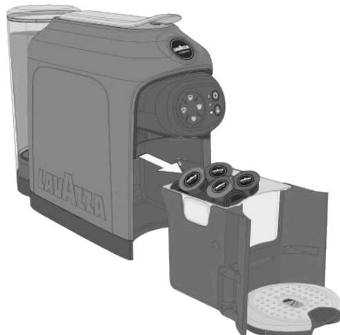
**i** En retirant le bac pendant plus de 5 secondes, la machine remettra à zéro le compteur de capsules introduites.
