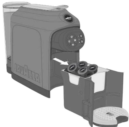
**i** Bleibt der Auffangbehälter länger als 5 Sekunden herausgezogen, setzt die Maschine die Zählung der eingesetzten Kapseln zurück.
