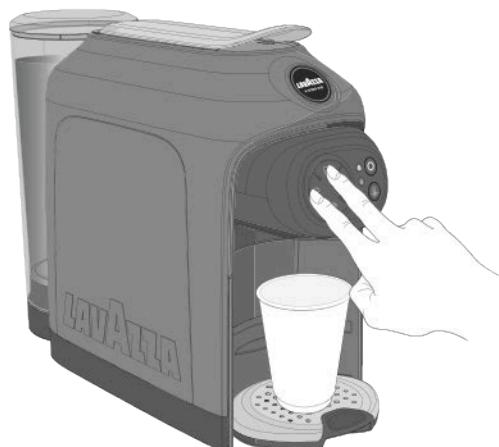
**i** La machine émet un long signal sonore tandis que les boutons On/stand-by O, DOSE LIBRE ☕ et le voyant détartrage s'allument fixe 🖤
