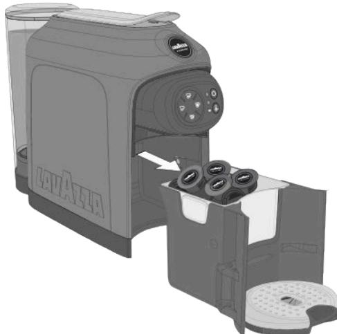
**i** Extrayendo el cajón durante más de 5 segundos, la máquina reajusta el cálculo de las cápsulas introducidas.
