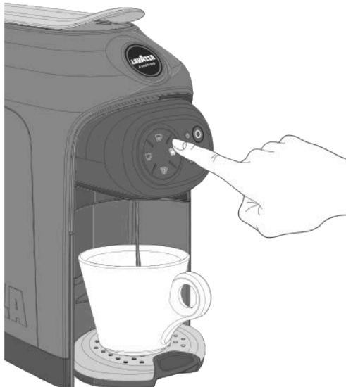
**i** Durante l'erogazione il pulsante selezionato è acceso con luce lampeggiante bianca. È possibile interrompere l'erogazione premendo nuovamente il tasto di erogazione.
