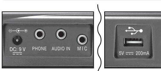
**DC 9 V** -Prise pour adaptateur de réseau (fourni).
