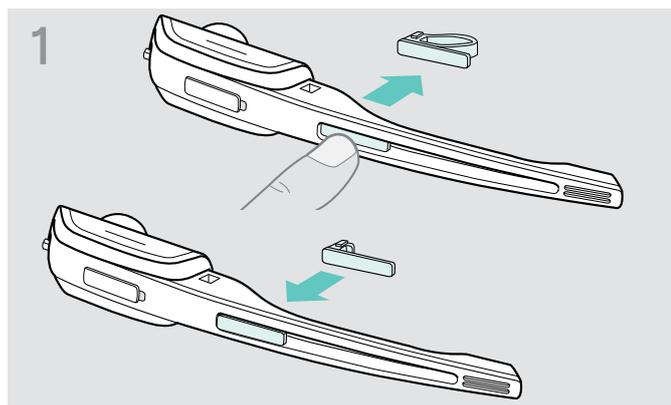
▷ Sostituire la targhetta identificativa con distanziatore con una targhetta identificativa semplice. Ciò è necessario per poter ruotare ancora liberamente il braccio del microfono dell'headset (vedere la figura 3).
