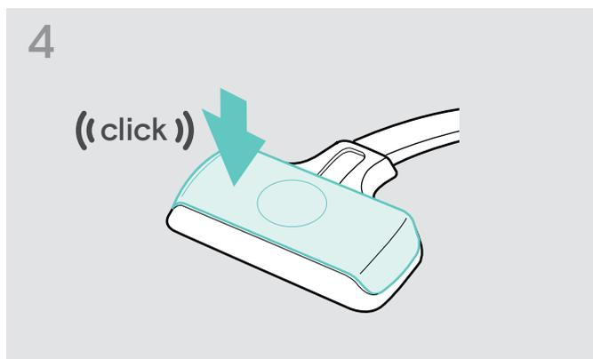
▷ Inserire il coperchio del vano batteria.
