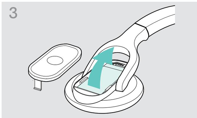
▷ Rimuovere la batteria e allentare attentamente il connettore dalla batteria.
