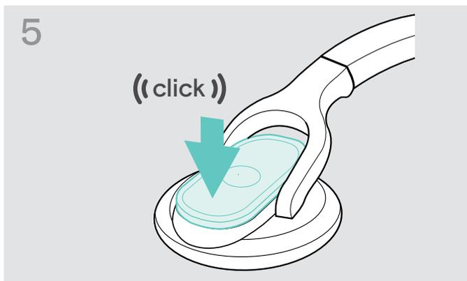
▷ Inserire il coperchio del vano batteria.
