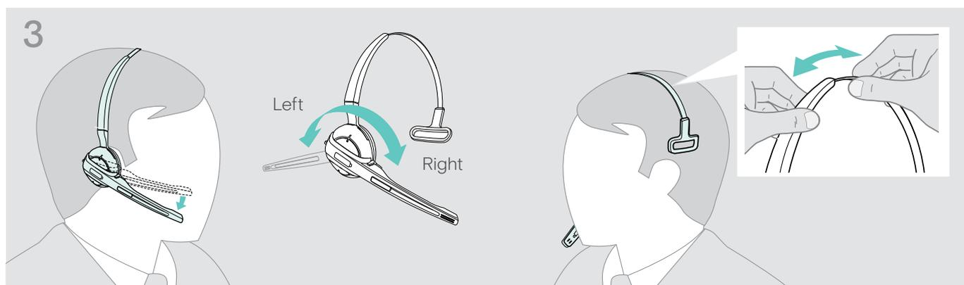
▷ Ruotare il braccio del microfono e indossare l'headset in modo che il cuscinetto auricolare sia posizionato in modo comodo sull'orecchio destro o sinistro.
