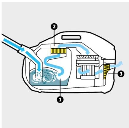
**Sistema di filtro multi-stadio, che consiste nell'innovativo filtro d'acqua, un filtro intermedio lavabile e un filtro HEPA 13 (EN1822:1998)**
