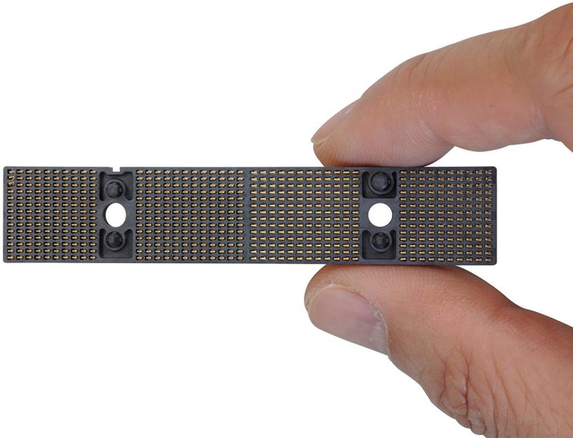
2. Rimuovere le 4 viti (M2x3.5) per fissare il modulo CAMM alla scheda di sistema.
