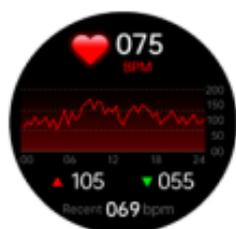
Selezionando l'interfaccia della frequenza cardiaca si avvierà la rilevazione in tempo reale della propria frequenza cardiaca. Verranno indicati anche i valori di frequenza cardiaca alta e bassa rilevati nella giornata.
