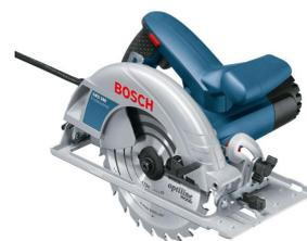
Bosch GKS 190. Diametro lama: 19 cm, Regime minimo (max.): 5500 Giri/min, Profondità di taglio (90°): 7 cm. Alimentazione: AC, Potenza ingresso: 1400 W. Peso: 4,2 kg. Valore di emissione oscillazioni: 2,5 m/s<sup>2</sup>, Incertezza K: 1,5 m/s<sup>2</sup>
